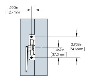
FIG. 8 GASKET 20408 (in-line base)
